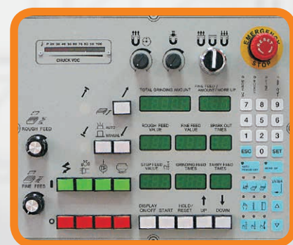
automatizovaný NC systém zastavení posuvu (typ AD5)
