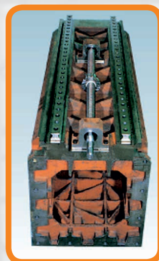
přesný kuličkový šroub a dvojitě lineární vedení
