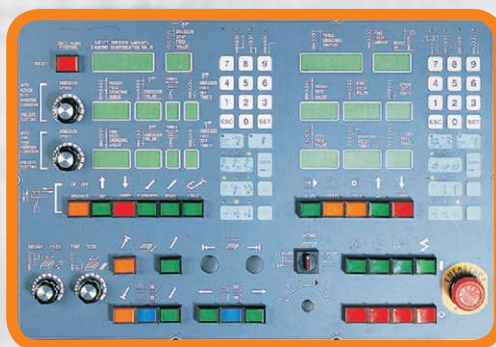
NC ovládací panel s funkcí orvnání
